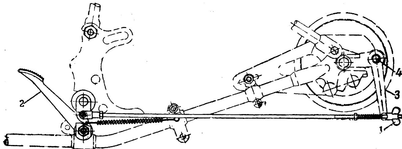
Рис. 11. Привод заднего тормоза:
