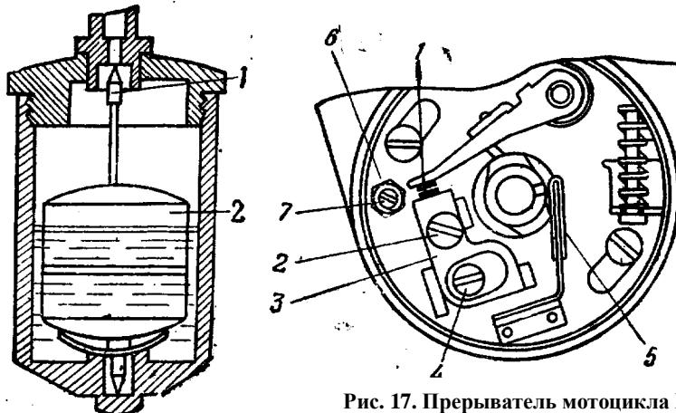
Рис. 16. Поплавковая камера:
