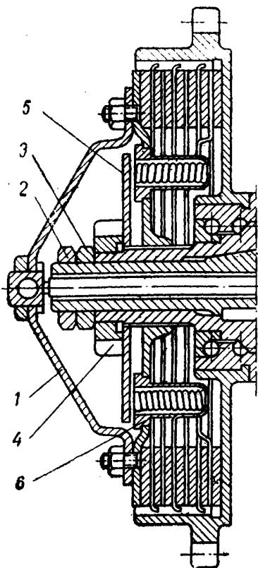
**Рис. 7.** Муфта сцепления мотоцикла АМ-600:
